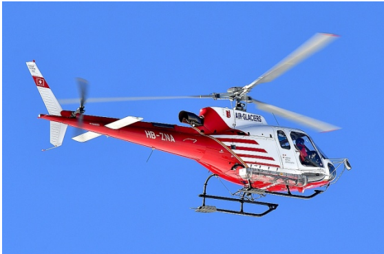
Der AS 350 B-3 Ecureuil HB-ZNA hatte die Funktion der „Pikettmaschine“. Der zur Flotte der Air Glaciers gehörende Hubschrauber ist mit dem „Maximum Pilot View Kit“ von Swiss Rotor Solutions (SRS) ausgestattet, mit dem die Sicht des Piloten im Aussenlasteinsatz markant verbessert wird.
